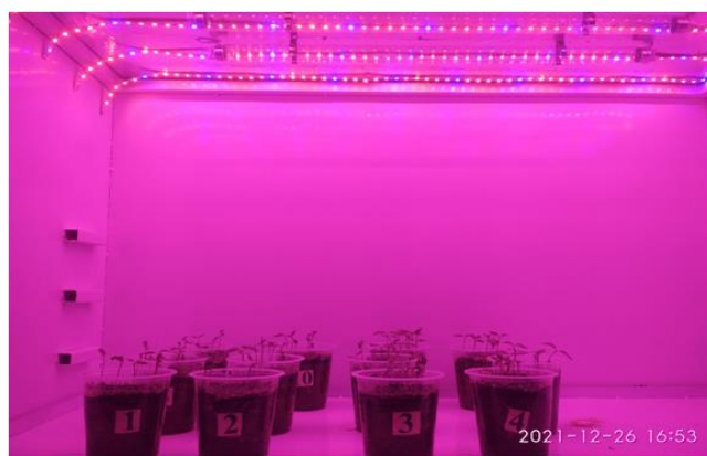
1-rasm. Shirin qalampir ko'chatlarini o'stirish uchun mo'ljallangan nurlatish qurilmasi.
