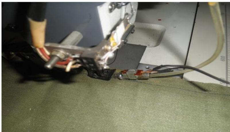
**Рис.1. Устройство полимерного покрытия швов брезентового материала**
