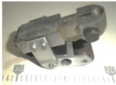
1-расм. Брезент материалнинг тикилган чокларига полимер композициясини қоплаш усқунасининг кўриниши
