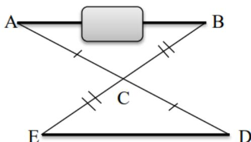
Пусть A и B – данные точки на местности, между которыми необходимо определить расстояние. Выберем точку C, из которой видны обе точки A и B. На продолжении отрезка AC за точку C отметим
