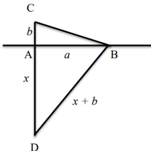
Измерим высоту  $b$  камыша над уровнем воды. Затем отклоним камыш так, чтобы его верхушка совпала с уровнем воды и, держа его в натянутом состоянии, замерим расстояние  $a$  между точками А и В, в которых камыш пересекает поверхность воды соответственно в вертикальном и наклоненном положении.
