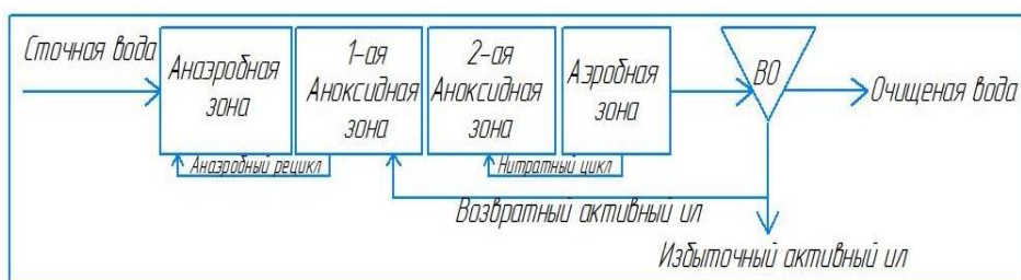
Рис. №1. Технологическая схема процесса станции биологической очистки сточных вод.
