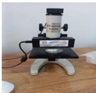
1-расм. Micron beta 3D юза ғадир-будурлигини ўлчовчи жихоз.
