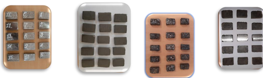
2-расм. Юза қисмига маълум таркибли қаттиқ қотишма ҳосил қилувчи материаллар пайвандлаб қопланган микрошлиф намуналари
