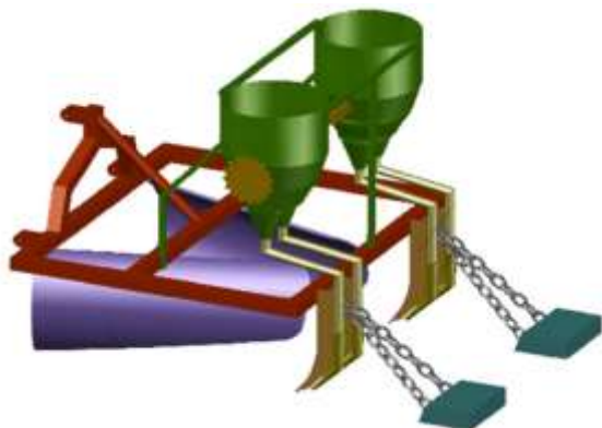
4-rasm. Takomillashgan pol hosil qiluvchi qurilmaning asosiy ko'rinishi
