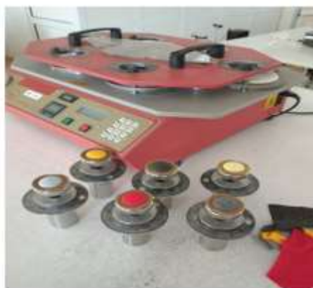
Рис. 1. Подготовка и испытания образцов на устойчивость к истиранию на приборе М 235/3
