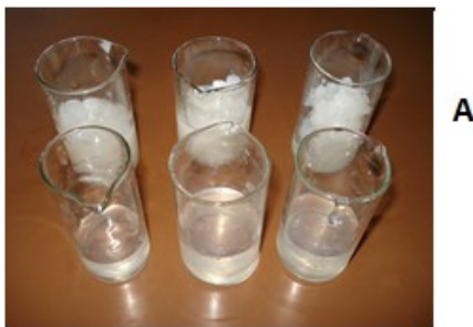
Рис.2. Охлажденные гидрогели клейстеров нативного (а) и окисленного (б) крахмала (соответственно из 5, 6, 7 % ных клейстеров) рисовой муки
