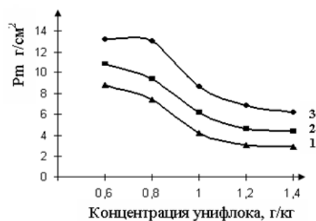
Рис.2. Зависимость пластической прочности P_m вторичной структуры полимерной композиции от концентрации ГИПАНа. Загустки на основе: 1- ОРК; 2- КМЦ; 3- ОРК- КМЦ
